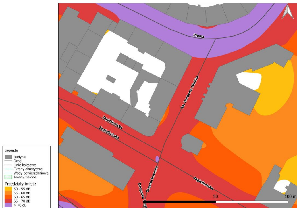
Rys. 8.15. Mapa emisji dźwięku – wskaźnik L_N , ul. ks. Herberta Hlubka na odcinku od ul. Jagiellońskiej do ul. Piwnej, przed zastosowaniem działań naprawczych
