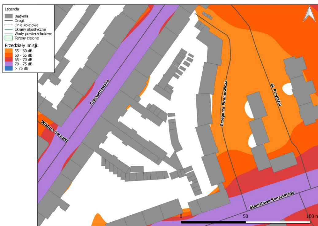
Rys. 8.10. Mapa imisji dźwięku – wskaźnik L_{DWN} , ul. Częstochowska na odcinku od ul. Wrocławskiej do ul. Jagiellońskiej, po zastosowaniu działań naprawczych
