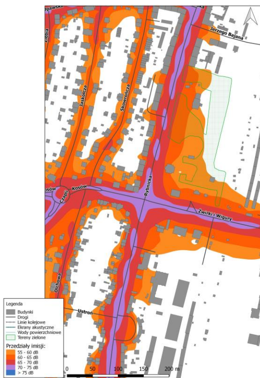
Rys. 8.42. Mapa imisji dźwięku – wskaźnik L_{dwn} , ul. Rybnicka na odcinku od ul. Żurawiej do ul. Kochanowskiego, po zastosowaniu działań naprawczych
