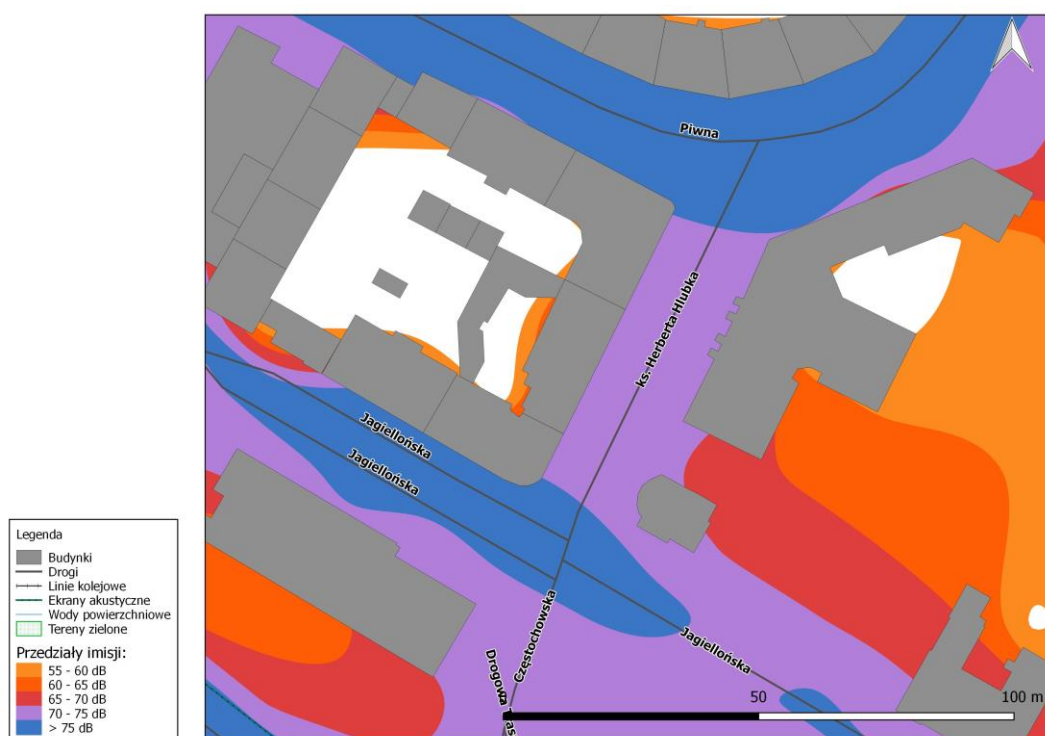
Rys. 8.14. Mapa imisji dźwięku – wskaźnik L_{dwn} , ul. ks. Herberta Hlubka na odcinku od ul. Jagiellońskiej do ul. Piwnej, po zastosowaniu działań naprawczych
