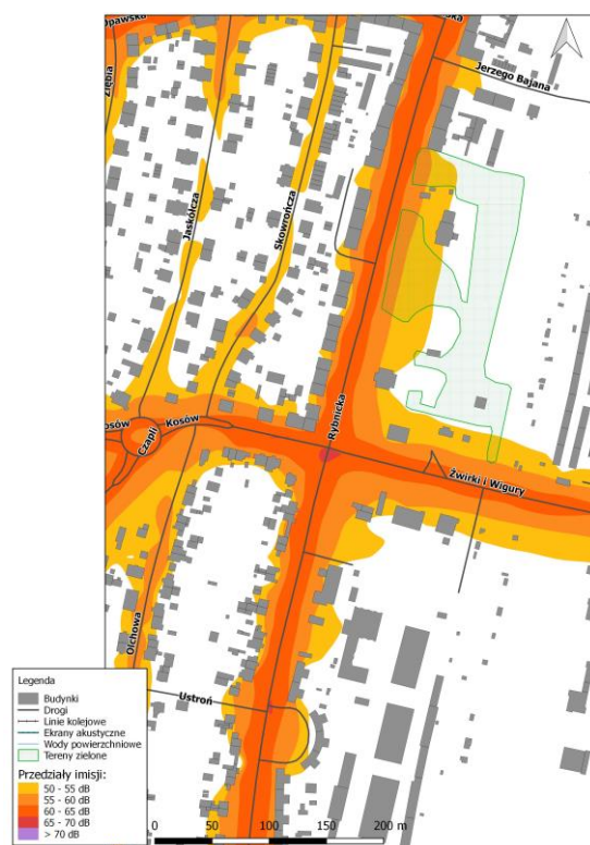
Rys. 8.44. Mapa emisji dźwięku – wskaźnik L_N , ul. Rybnicka na odcinku od ul. Żurawiej do ul. Kochanowskiego, po zastosowaniu działań naprawczych
