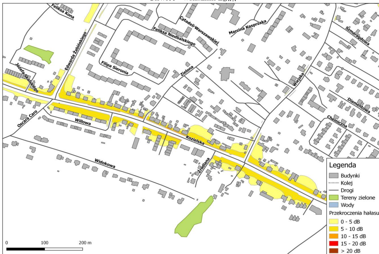
Rys. 3.5. Wycinek mapy przekroczeń poziomu hałasu pochodzącego od ruchu drogowego na terenie Miasta Gliwice - wskaźnik L_{DWN}
