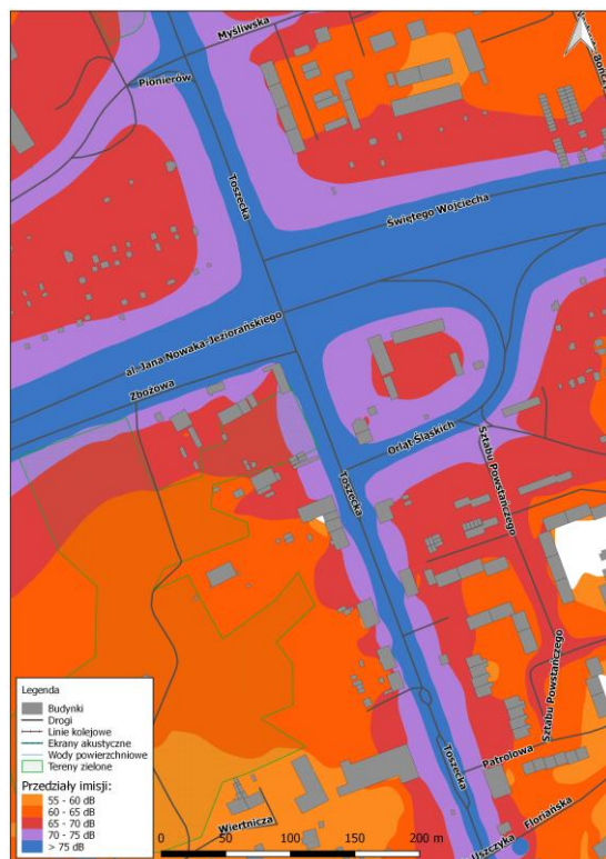
Rys. 8.49. Mapa emisji dźwięku – wskaźnik L_{dwn} , ul. Toszecka na odcinku od ul. Sokoła do ul. Jana Śliwki, przed zastosowaniem działań naprawczych
