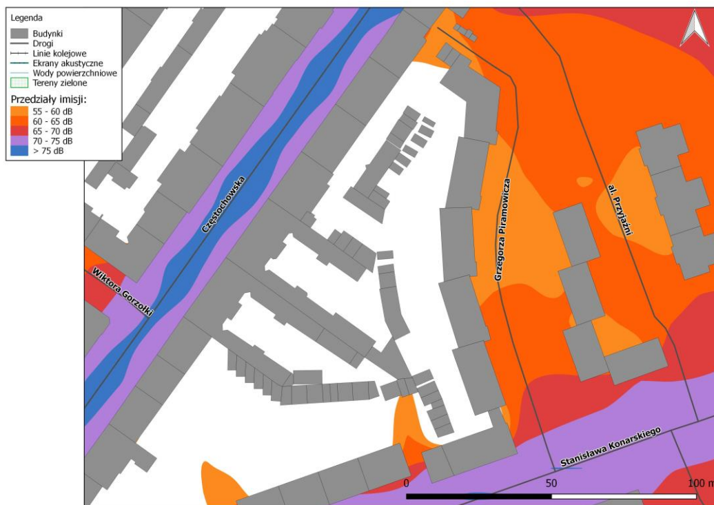
Rys. 8.9. Mapa imisji dźwięku – wskaźnik L_{DWN} , ul. Częstochowska na odcinku od ul. Wrocławskiej do ul. Jagiellońskiej, przed zastosowaniem działań naprawczych
