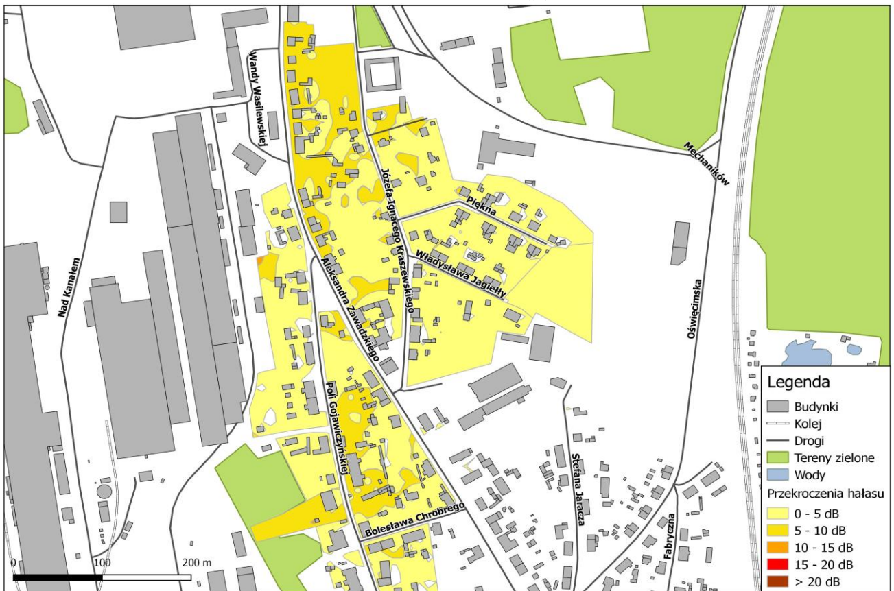
Rys. 3.7. Wycinek mapy przekroczeń poziomu hałasu przemysłowego na terenie Miasta Gliwice - wskaźnik L_{DWN}
