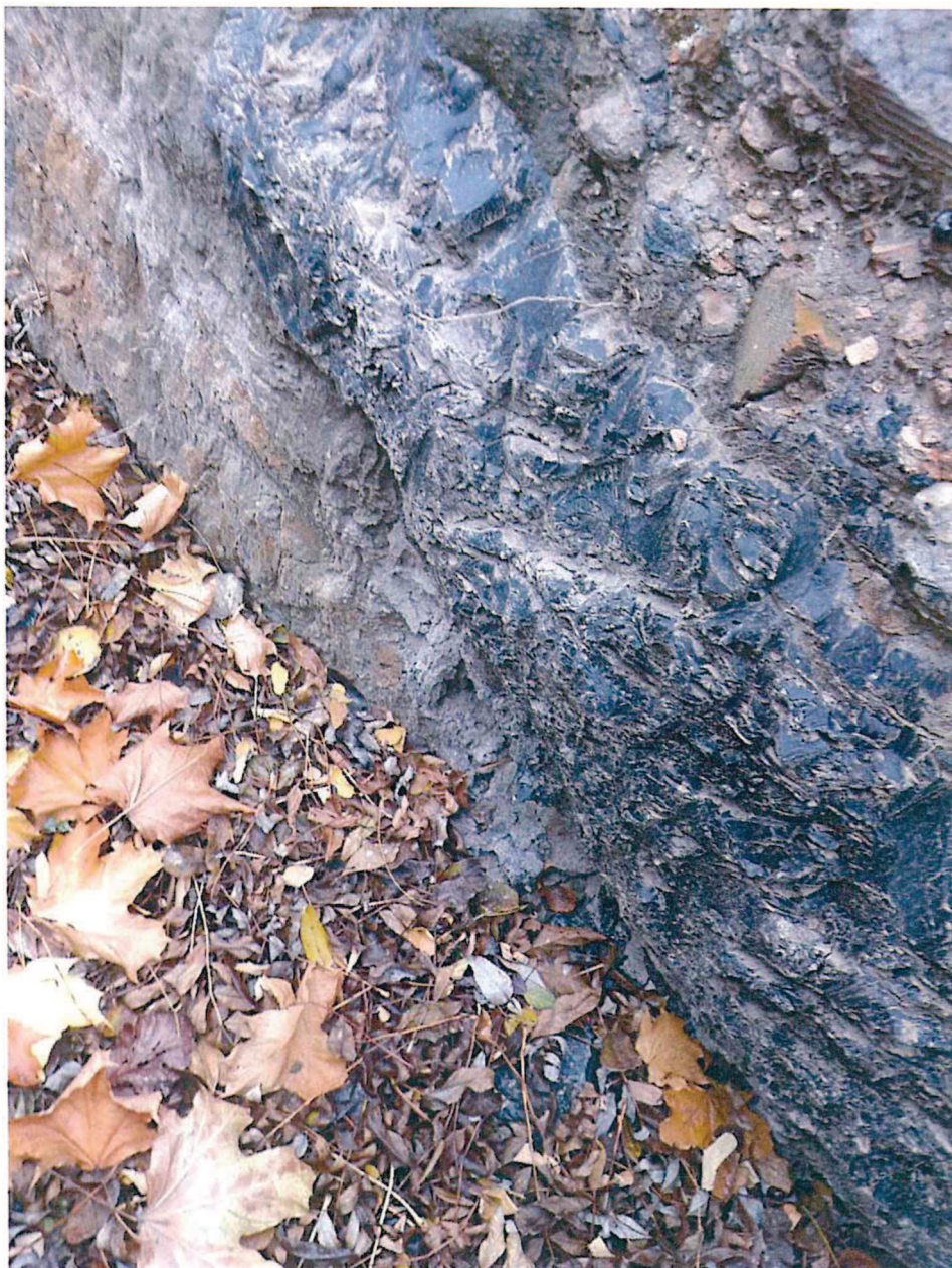
Rys 3. - występowanie odpadu na spodzie wykopu
